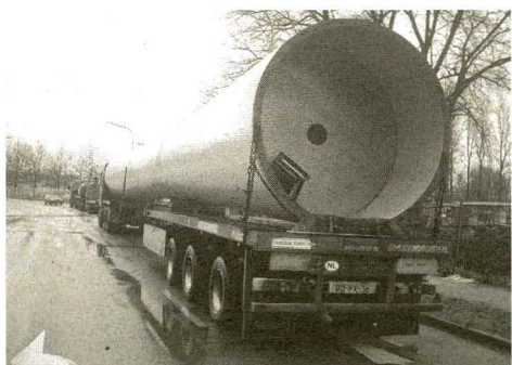
3) Antransport der Windmühlenteile mit 7 Spezialfahrzeugen
